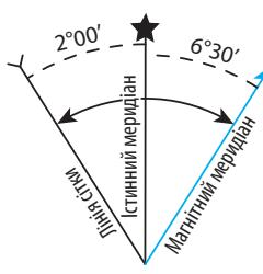
**Мал. 2.** Схема взаємного положення меридіанів на топографічних картах: істинний меридіан позначають зірочкою, магнітний — прямою стрілкою, лінію кілометрової сітки — зворотною стрілкою.
