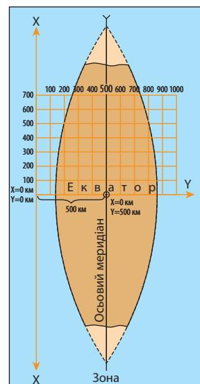
**Мал. 5.** Система плоских прямокутних координат однієї зони. Координата  $Y$  осьового меридіана зони дорівнює 500 км.
